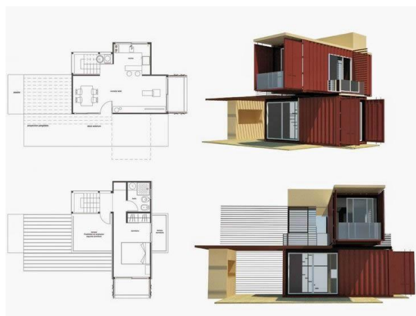
Figura 4 – Planta baixa e volumetria de casa feita com contêiner Fonte: Casa do Container.
