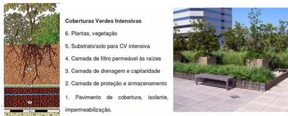
Figura 10 – Camadas Telhado Intensivo / Exemplo em Houston-USA
