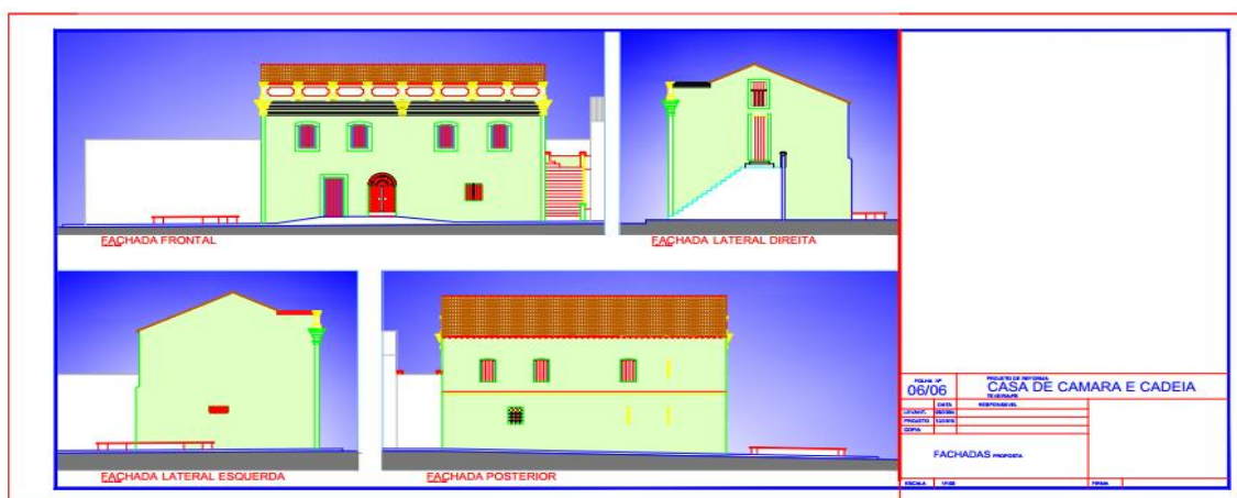
Figura 4 – Proposta para a fachada principal frontal, lateral direita e esquerda e lateral posterior da Cadeia Velha do município de Teixeira-PB
