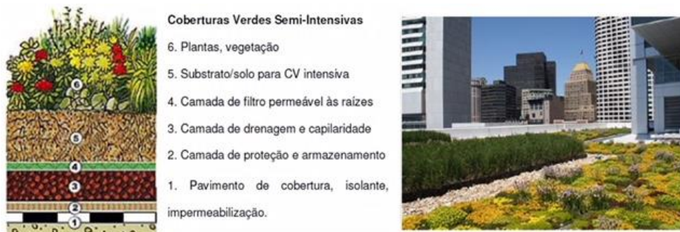
Figura 11 – Camadas Telhado Semi-Intensivo / Exemplo em Boston-USA
