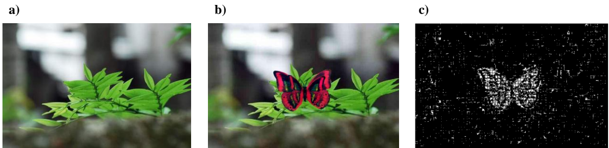
Figura 6. (a) Imagem original. (b) Imagem manipulada pela técnica de composição. (c) Resultado obtido a partir da verificação da inconsistência dos blocos JPEG.
